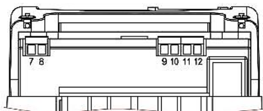
а) обозначение контактов счетчика с интерфейсом RS-485
